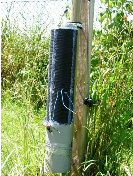
Ladespule für die 40m Drahtantenne mit verschiedenen Abgriffen
